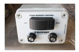
Fig. 15 FOAM MARKER CONTROLLER
