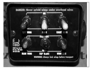
Fig. 14 BOOM POSITION SWITCH BOX
