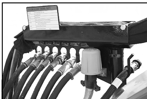
Кабелі і шланги в положенні зберігання
