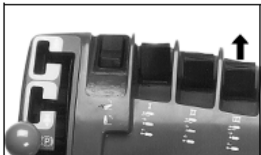
SCV III установлен в положение «FLOAT» (ПОПЛАВКОВЫЙ)
