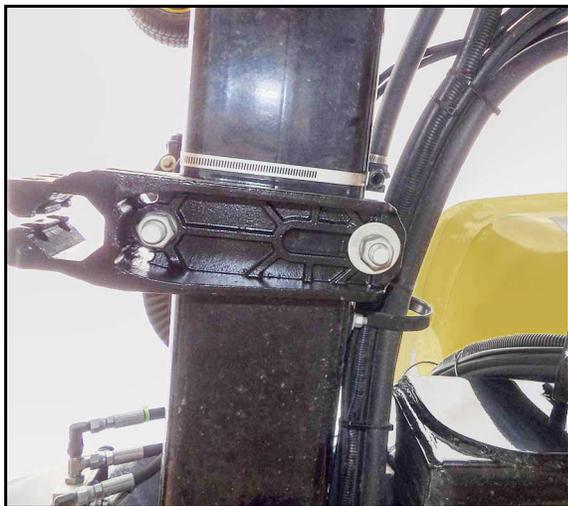
Положение гайки и шайбы для крепления сошника.
