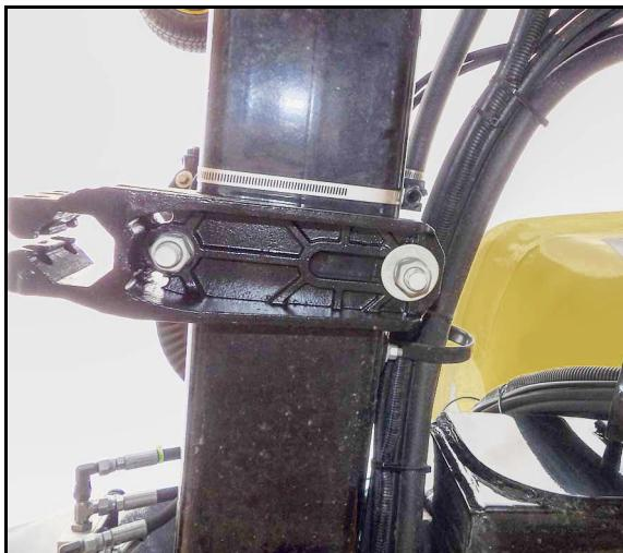
Положение гайки и шайбы для крепления сошника.
