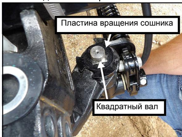
Сошник поворачивается на 45 ° с помощью пластины вращения сошника, которая устанавливается в положении отсутствия вращения.
