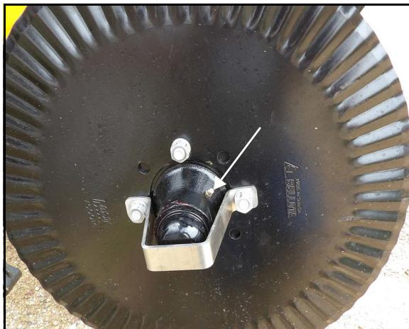
1. Смазывайте ступицы сошника с помощью поставляемых масленок каждые 100 часов использования, до и после хранения.
