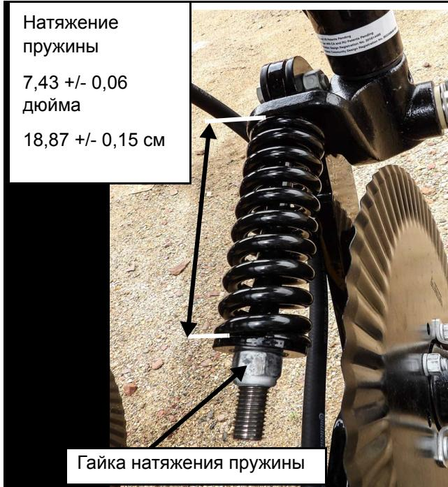
Настройайте давление прижима с помощью гайки натяжения пружины.
