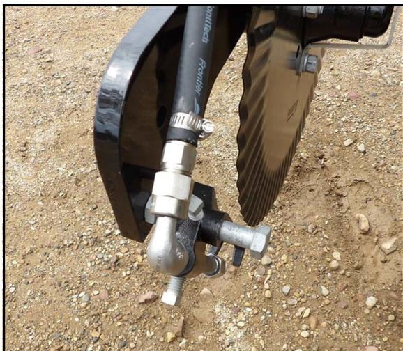
1. Визуально настройте положение форсунки инжектора относительно сошника. Для настройки угла форсунки:
