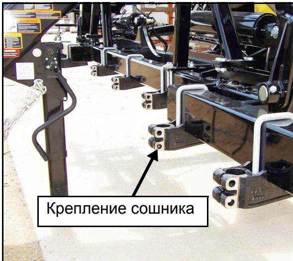
1. Определите место каждого крепления сошника. При необходимости измените место крепления.
