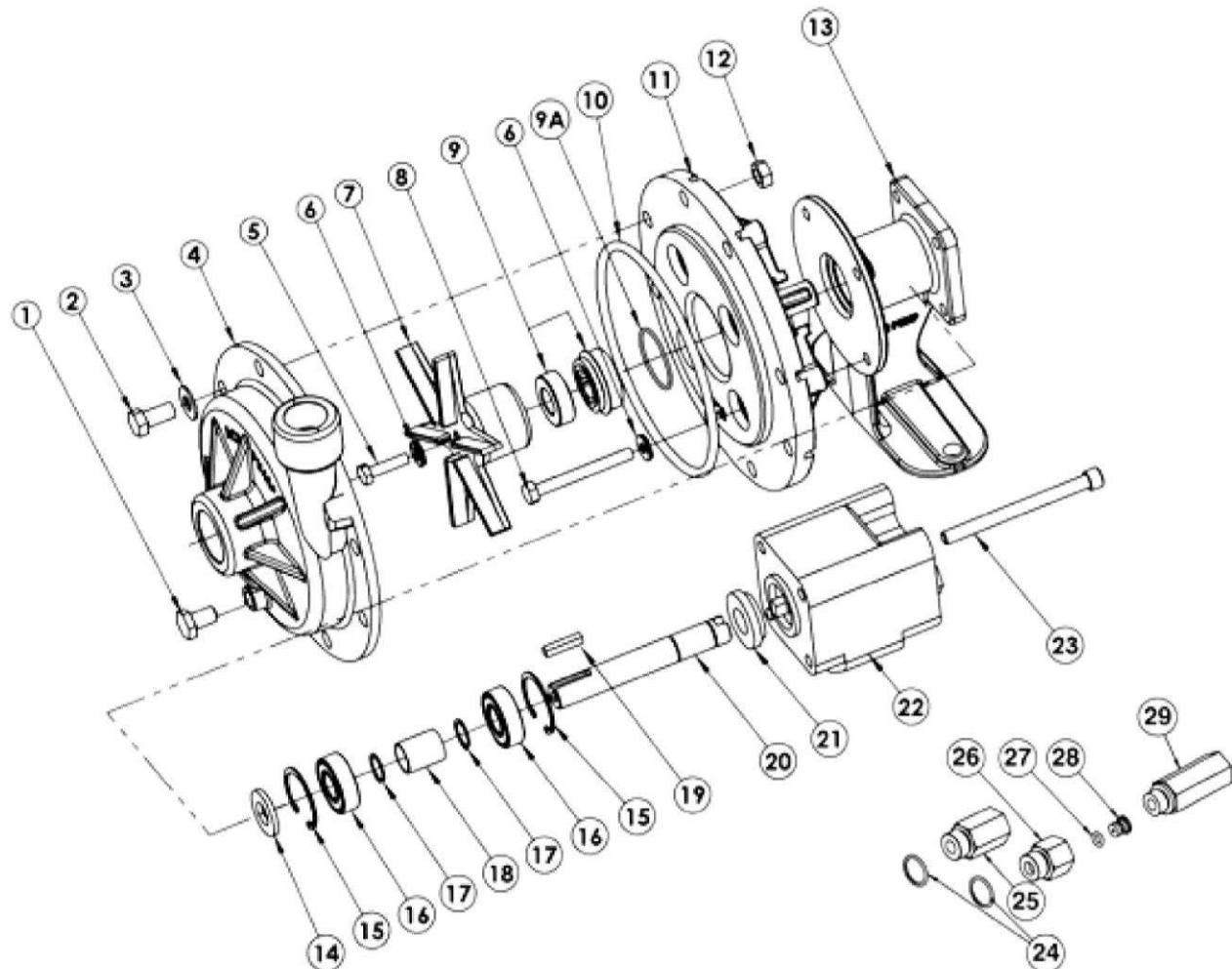
**Parts List: Ace FMC-75-HYD Pump – Parts Breakdown**
