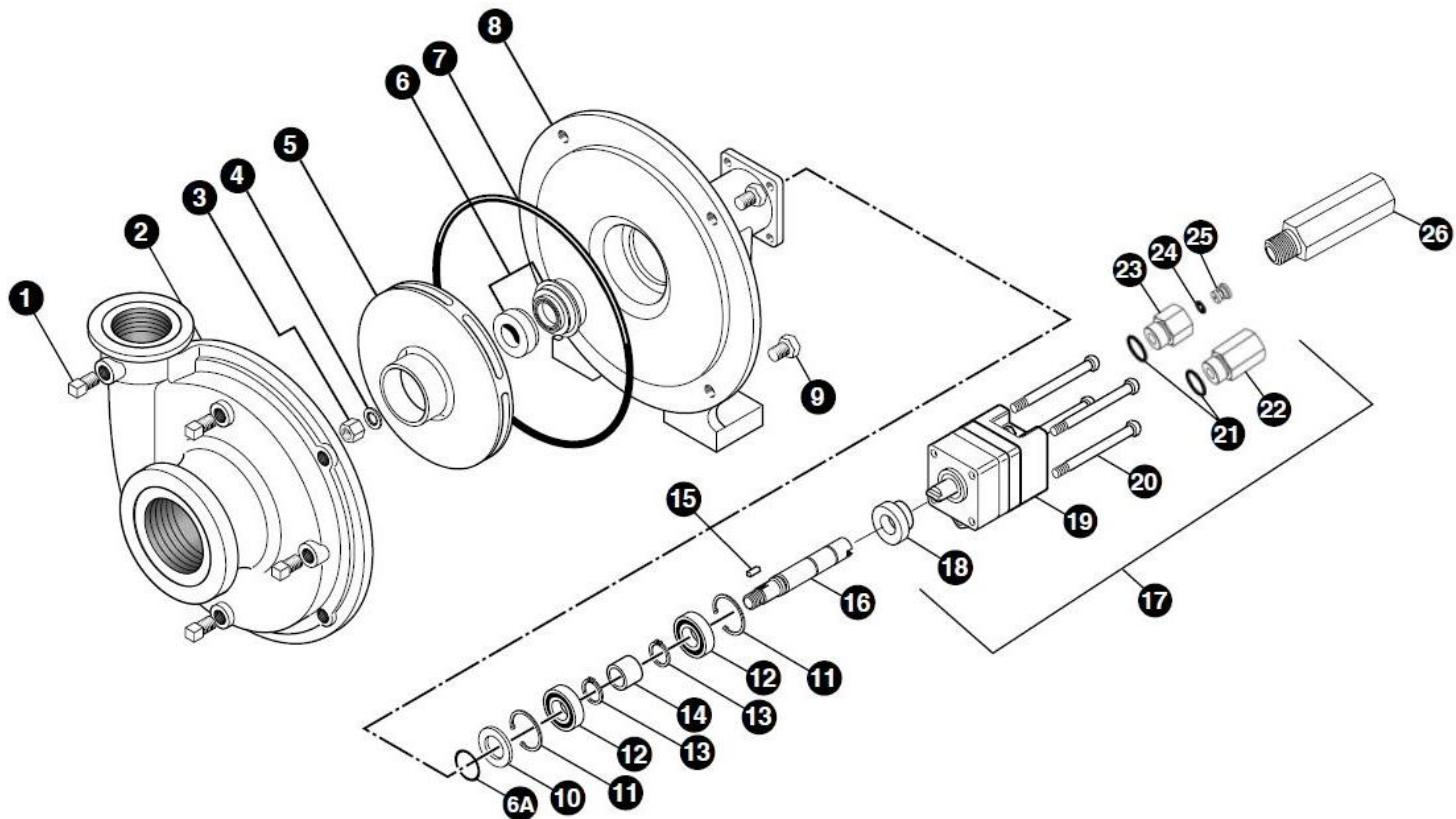
**Parts List: Ace 150 HYD Pump – Parts Breakdown**
